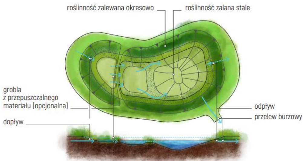
Rysunek 54. Schemat typowego stawu retencyjnego, widok z góry i przekrój.
